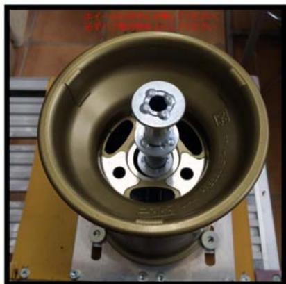
ホイールの取付け向きに注意してください。必ずハブ側が上になるように取付けて下さい
