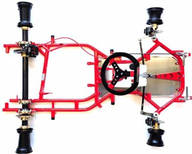
PHOTO VUE DE DESSUS DU CHÂSSIS COMPLET IDENTIQUE À L'UN DES MODÈLES PRÉSENTÉS À L'HOMOLOGATION SANS PARE-CHOC, CARROSSERIE, SIEGE, NI PNEUMATIQUES
