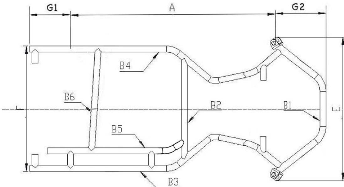
Représenter seulement les tubes principaux de la structure et les attaches supportant les fusées et les barres de rigidification nécessitant informations et dimensions à la section B
