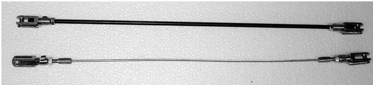
**La commande de freinage doit être isolée du châssis et montrer la double commande**
