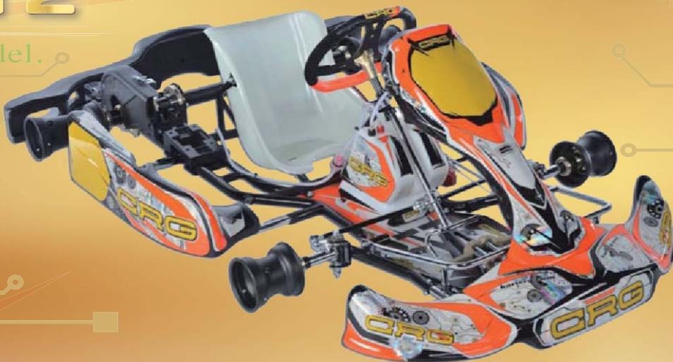
フロントセクションではナックルのキングピンアングルはそのままにボールジョイント取り付け位置を変更、ステアリングシャフト側もナックルの変更に合わせてボールジョイント取り付け位置を変更、これらの変更によりアッガーマン効果が変わり、フロントタイヤの追従性を向上させました。
