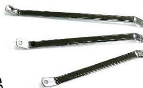
RR シートステー / フラット サイズ：芯々(ボルト穴間隔) 280/300/320/340mm
